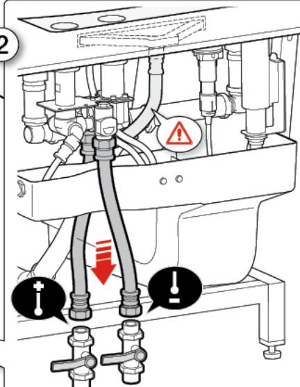
Instalar el dispositivo de protección contra reflujo, dependiendo de la normativa local vigente. Para cumplir con la norma EN-1717, Instalar la referencia Roca: A248312000
