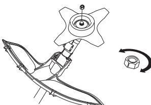
Найлоновото застопоряване на контрагайката не бива да бъде износено до степен, че да може да се върти с пръсти. Защото застопоряването трябва да издържа поне на усилие равно на 1,5 Нм. Гайката трябва да се смени след като е завинтвана около 10 пъти.
