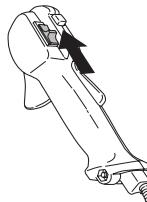
**ВНИМАНИЕ!** Изключвателят автоматично се връща на първоначалното си положение. За да предотвратите неумислено запалване капачката на свещта трябва да бъде отстранена от свещта при монтиране, проверка и/или провеждане на техническа поддръжка.
