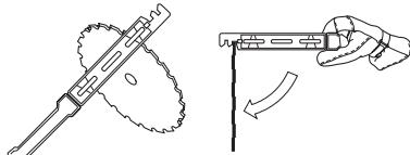
Проверявайте режещото оборудване за повреди и образували се пукнатини. Повредено режещо оборудване подлежи винаги на подмяна.
