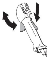
Вижте инструкциите в раздел Стартiranе. Стартирайте устройството и подайте пълна газ. Отпуснете регулатора на газ и се убедете, че режещото оборудване спира и остава неподвижно. Ако след като поставите подаването на газта на празен ход, режещото оборудване продължава да се връти, трябва да се провери регулировката на празния ход на карбуратора. Виж инструкциите в раздел Поддръжка.
