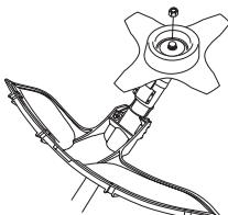
При монтирането гайката следва да се затяга в обратната посока на въртенето на режещото оборудване. При демонтиране гайката следва да се отвинта по посока на въртенето на режещото оборудване. (ЗАБЕЛЕЖКА! Гайката има левоходова резба.) Затегнете гайката с глухия ключ.
