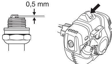
**ВНИМАНИЕ!** Използвайте винаги запалителните свещи от препоръчания вид! Използването на погрешен тип свещи може да предизвика сериозни повреди на буталото/цилиндъра.
