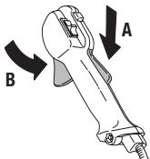
Уверете се, че регулаторът на дроселната клапа е в положение на празен ход, когато фиксаторът на дроселната клапа се намира в изходното си положение.
