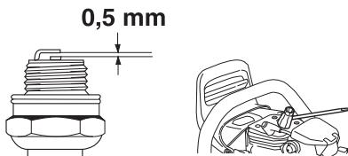
**ЗАБЕЛЕЖКА!** Използвайте винаги запалителните свещи от препоръчания вид! Използването на погрешен тип свещи може да предизвика сериозни повреди на буталото/цилиндъра. Убедете се, че запалителната свещ е снабдена със защита от радиосмущения.
