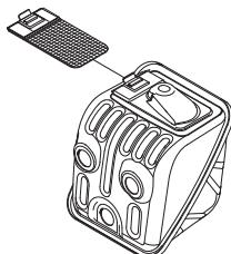
Ауспухът е предназначен за намаляване равнището на шума и насочване на отработените газове встриани от оператора. Отработените газове са нагрети и могат да съдържат искири, които да предизвикат пожар, когато попаднат върху сух и горлив материал.
