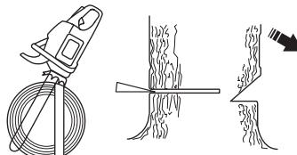
Поваляящият срез трябва да завърши успоредно на линията на направляващия срез, като разстоянието помежду им трябва да бъде най-малко 1/10 от диаметъра на стъблото. Несрязаната част на дървото се нарича предпазна ивица.
