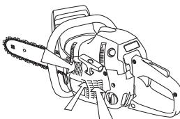
**ЗАПОМНЕТЕ!** За да действа центробежното почистване е необходимо да се провежда редовна поддръжка. Почистете устройството за засмукване на въздух в стартера, перките на вентилатора на маховика, пространството около маховика, входната тръбичка и пространството на карбуратора.
