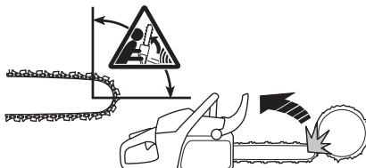
Обратният тласък е винаги в посока на шината. Обикновено верижният трион и шината се отхвърлят назад и нагоре, по посока на оператора. Но верижният трион може да отскочи и в други посоки в зависимост от
