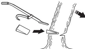
Препоръчваме ви да използвате шина, която е по-дълга от диаметъра на дървото, така че да можете да правите основния срез и насочвате срезове с "единични режещи движения". Вижте инструкциите в раздела със заглавието Технически данни относно кои дължини на шината се препоръчват за вашия модел моторен трион.
