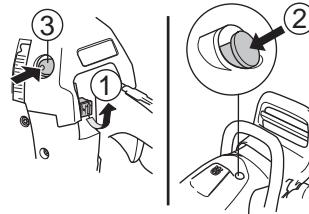
Хванете предната дръжка с лявата ръка. Сложете десния си крак в захвата за обувка в долната част на задната ръкохватка, като натискате машината към земята.
