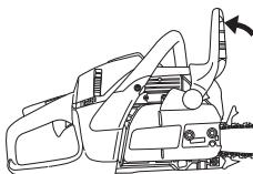
Отвинтете гайките на шината и свалете капака на съединителя. Свалете защитата за транспортиране (A).
