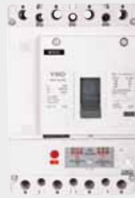
Kaçak Akımlı Kompakt Şalter, VMR In : 50A – 250A Icu : 25kA, 35kA IΔn : 100mA, 300mA, 500mA
