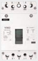
Termik Ayarlı Kompakt Şalter, VMT In : 16A – 400A Icu : 35kA, 50kA Irs : 0.7 – 1 In
